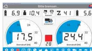
Während der Bremsprüfung werden alle relevanten Daten übersichtlich dargestellt.
